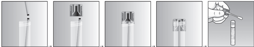
Abb. 1 Ergreifen des abgebrochenen Tupferschafts durch die MSwab® Verschlusskappe
