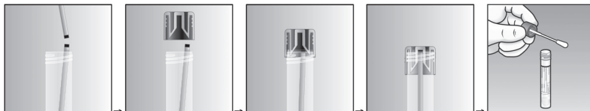
Fig. 1. Captura de la varilla rota del aplicador del hisopo en el tapón del tubo MSwab®
