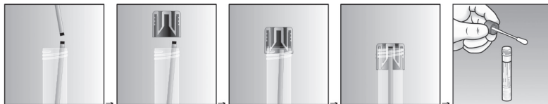
Σχήμα 1. Ανγκίστρωση της σπασμένης ράβδου ρυθμιστικού διαλύματος από το καπάκι σωλήνα MSwab®
