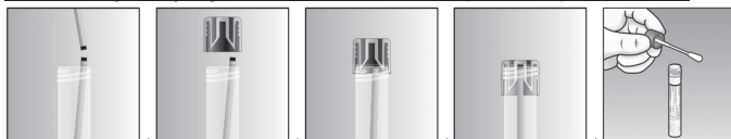
Slika 1. Sidranje zlomljenega stebila vatenke za bris s strani pokrovčka epruvete MSwab®
