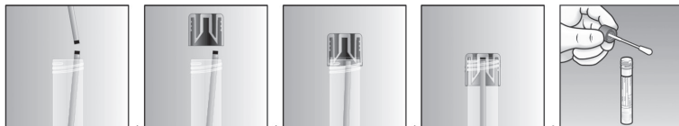
Fig 1. Bilde av brutt applikatorkaft med MSwab®-rørhetten
