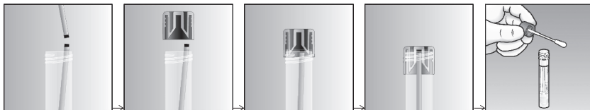
Fig. 1. Captura da haste partida do aplicador da zaragatoa pela tampa do tubo UTM-RT ®
