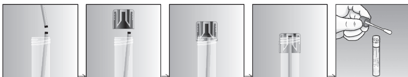
Fig 1. Podepindsapplikatorens knækkede skaft fanges af UTM-RT ® -rørets hætte
