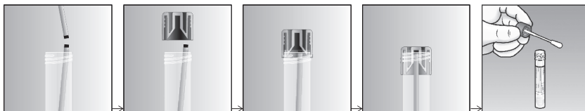
Afb. 1. Het afgebroken applicatorstaafje vastzetten met de dop van het UTM-RT ® -buisje
