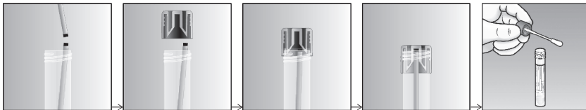
Kuva 1. Kerää katkennut puikkoapplikaattori UTM-RT®-korkilla
