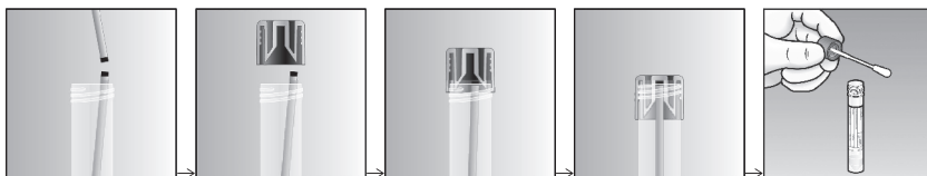
Fig. 1: Fangst av brukket vattapplikatorpinne med lokk til UTM-RT ® rør
