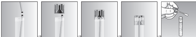
Fig. 1. Captarea tije rupte a aplicatorului tamponului de către capacul tubului UTM-RT ®
