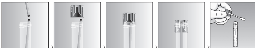
Obr. 1. Zachycení zlomené tamponové aplikační tyčinky uzávěrem zkumavky UTM-RT ®
