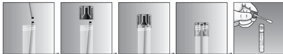
Fig 2. Blockeringen av den avbrutna provtagningspinnen av gripkorken MSwab™
