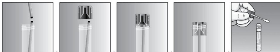
Fig 2. Blocage de la tige de l'applicateur de l'écouvillon brisée par le bouchon de l'éprouvette MSwab™
