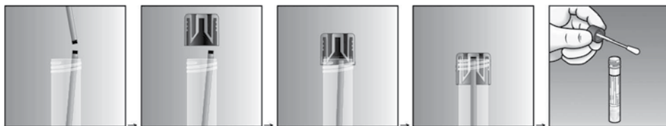
Fig 2. Bloqueio da haste do aplicador do zaragatoa partido da parte da tampa do tubo de ensaio MSwab™
